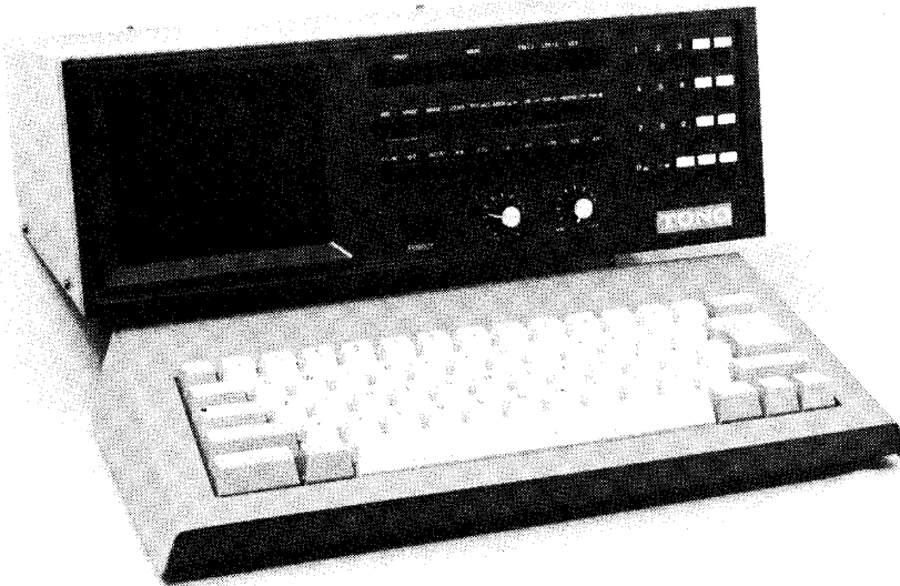
TONO Theta 5000 E, ALL-MODE COMMUNICATIE TERMINAL. CW, BAUDOT, ASCII en nu ook TOR ARQ en FEC.
