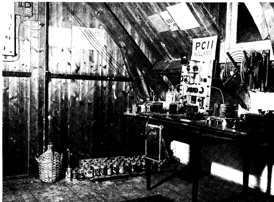
De amateurzender PCII te Leiden. Op de grond de elektrolytische gelijkrichter die een gelijkspanning van 220 volt produceerde. (Zie ook de foto op onze voorpagina.)
